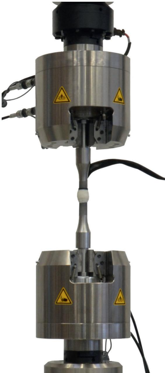
Diese Spannzeuge generieren eine, unabhängig von der wirkenden Prüfkraft, konstante hydraulische Spannkraft wodurch wiederholbare Prüfergebnisse erzielt werden können.
